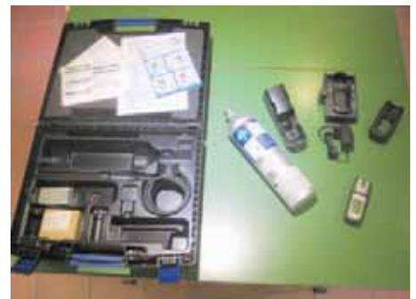
Ein Gasmessgerät der Firma Dräger beschaffte die FF Wiesau. Mit diesem Gerät können folgende Stoffe gemessen werden: CO<sub>2</sub>, CH<sub>4</sub>, O<sub>2</sub>, CO und H<sub>2</sub>S. Untergebracht ist das Gerät im ELW1. Die Alarmierung erfolgt über eine separate Melderschleife.
