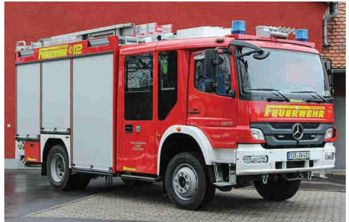
Das neue LF 20 der Feuerwehr Waldershof ersetzt das 36 Jahre alte Tanklöschfahrzeug (TLF 16/25). Als Fahrgestell kommt ein Mercedes Atego 1629 AF mit einem zulässigen Gesamtgewicht von 16 t, 290 PS und Automatikgetriebe zum Einsatz.
