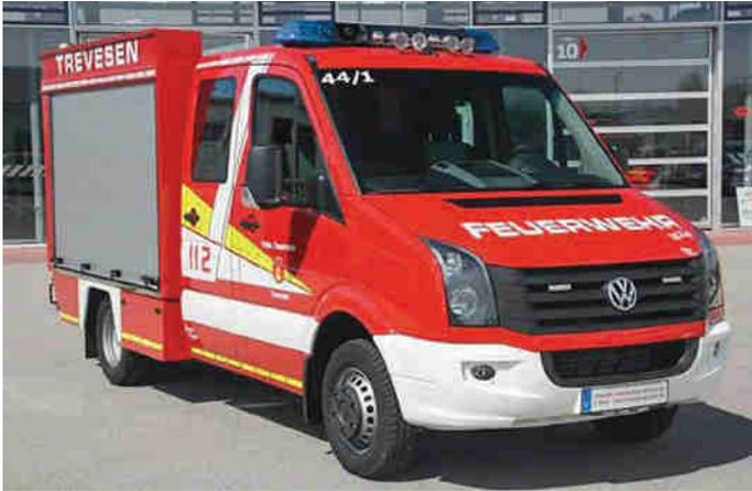
Im Mai 2017 konnte die Feuerwehr Trevesen ein neues TSF, einen VW Crafter mit einem zulässigen Gesamtgewicht von 4,5 t in Dienst stellen. Aufbau und die feuerwehrtechnischen Umbauten wurden von der Firma Furtner & Ammer in Landau durchgeführt. Das Fahrzeug ist mit einem integrierten, pneumatisch ausfahrbaren LED-Lichtmast, LED-Umfeldbeleuchtung sowie einer Heckwarnanlage ausgestattet.
