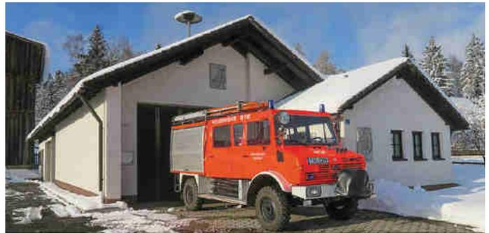
Der Unimog mit 750-Liter-Löschmitteltank (Pumpe 6/6), Vorbau-pumpe 8/8 und Platz für eine Löschgruppe wurde im November 2004 von der Feuerwehr Pohlheim in wirklich gutem Zustand erworben und entsprechend den Anforderungen umgebaut und auf Vordermann gebracht.
