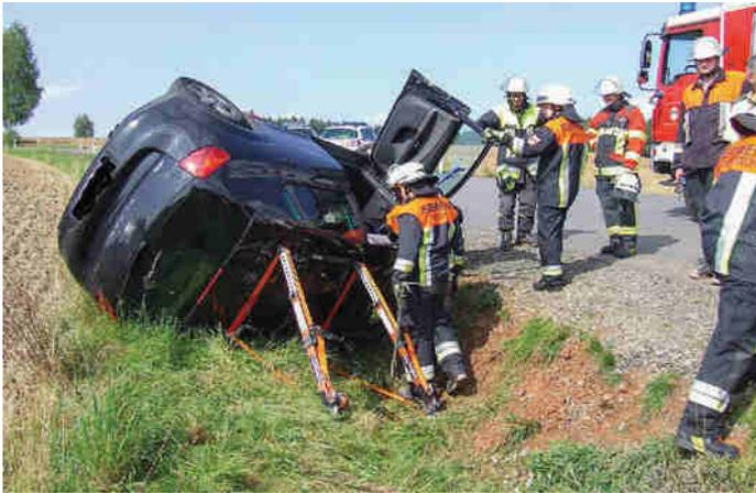
Bei diesem Verkehrsunfall in der Nähe von Dobrigau, wurde das von der Feuerwehr Mitterteich neu beschaffte Holmatro-Stabilisierungssystem zum ersten Mal eingesetzt. Das System dient dazu, Fahrzeuge nahezu in jeder Lage zu stabilisieren. So ist ein sicheres Arbeiten für die Rettungskräfte garantiert und die Unfallopfer können möglichst schonend aus dem verunfallten Fahrzeug gerettet werden.
