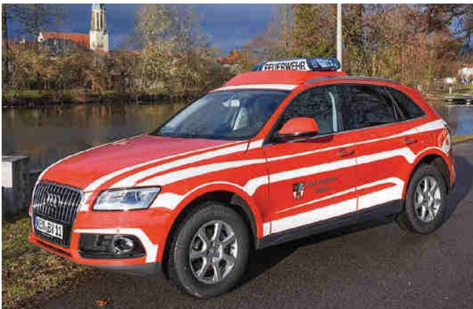
Bei dem neuen KdoW handelt es sich um einen Audi Q5 mit reflektierender Designbeklebung. 190 PS erbringt der zwei Liter Turbodieselmotor. Der Allradantrieb und die große Bodenfreiheit versprechen mehr Geländegängigkeit und Sicherheit bei jeder Witterung. Den Einbau der umfangreichen feuerwehrtechnischen Ausrüstung übernahmen die Feuerwehrleute mit den Gerätewarten in Eigenregie.
