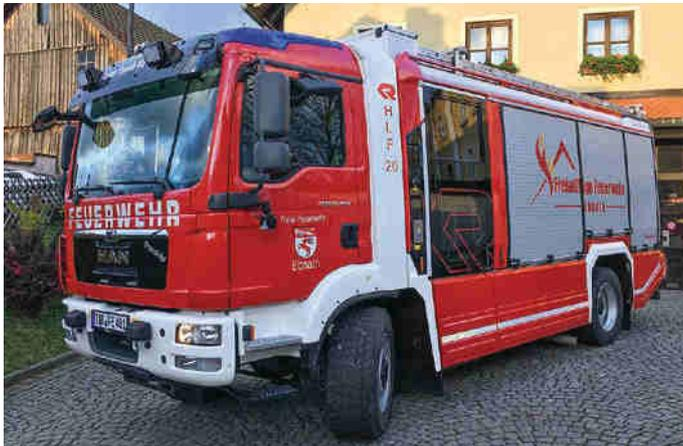
Das neue HLF 20 von Rosenbauer auf MAN TGM 13.290 4x4 ersetzt das 37 Jahre alte Tanklöschfahrzeug (TLF 8/18) der Feuerwehr Ebnath. Das Fahrzeug wurde mit einer Leistung von 296 PS, automatisiertem Schaltgetriebe und permanenten Allrad ausgerüstet.
