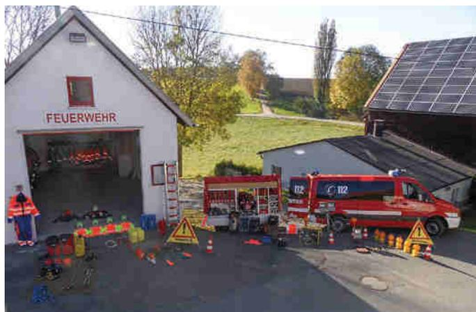
Das aktuelle Einsatzgespann der Kötzersdorfer Wehr – bestehend aus einem VW Crafter als Mannschaftstransportwagen – größtenteils mit THL-Ausrüstung – in Verbindung mit einem Tandemanhänger mit Planen-Aufbau, in dem alle Gerätschaften für einen Löscheinsatz verlastet sind – steht der Wehr seit 2011 zur Verfügung. Es hat sich herausgestellt, dass diese Lösung eine sehr gute ist, da man je nach Einsatzart sehr schlagkräftig reagieren kann.
