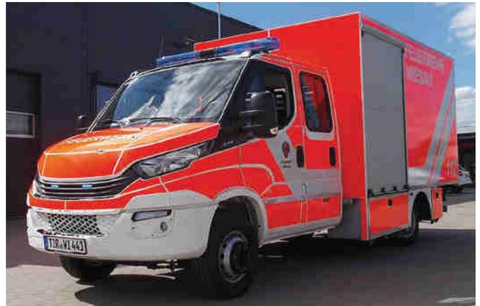
Das Neufahrzeug, ein 7-Tonnen-Fahrgestell der Firma IVECO, wurde von der Firma Compoint aus Forchheim aufgebaut. Das TSF-L besitzt einen 170-PS-Dieselmotor mit Schaltgetriebe, eine Doppelkabine sowie einen gesonderten Heckgeräteraum mit einer Ladebordwand.
