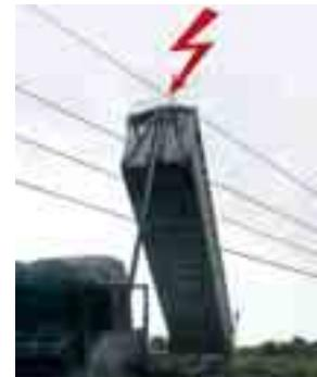
Die Berührung des Bodens mit einem Hochspannung führenden Teil setzt das umliegende Erdreich unter Spannung!
